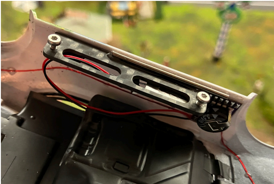
Bild 07: Beispiel für die Positionierung eines Trimmgewichtes und der Lichtplatte im inneren Schwellerbereich.
